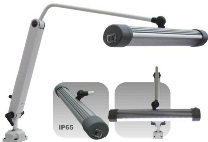
Lampada regolabile per postazioni di lavoro. Struttura in alluminio anodizzato. Sorgente luminosa composta da 24 power LED 13W. Riflettore in alluminio con copertura in policarbonato. Braccio snodato. Interruttore sulla testa della lampada. Alimentatore 48Vdc integrato. Alimentazione 230V 50/60Hz (cavo con spina).
