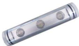
Sistema di illuminazione tubolare modulare a tecnologia LED in alluminio e policarbonato. Sorgente luminosa a 3 power LED con lenti da 8°-25°-40°. Clips di fissaggio. Alimentatore esterno separato. Corrente operativa: 350-500-700mA (! utilizzare solo alimentatori elettronici stabilizzati in corrente continua).
